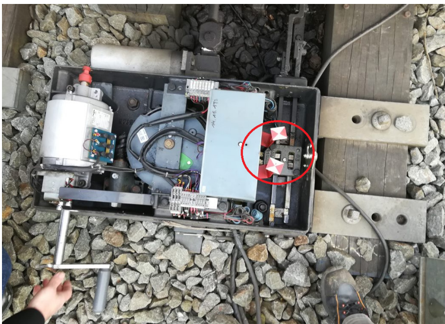
Afbeelding: Binnenkant van de motorbehuizing van wissel 02C. De diablo's zijn te zien in de rode cirkel en de noodhendel linksonder op de foto.
