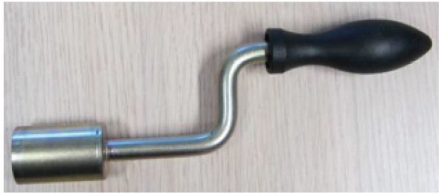
Afbeelding: Een noodhendel (bron: Infrabel)
